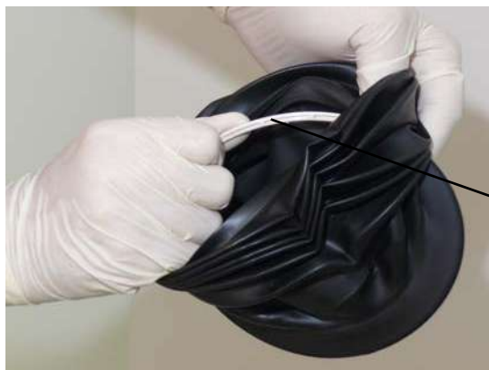
РИСУНОК 7-8 Удаление адаптерного кольца сильфона
