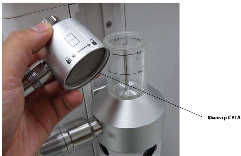
РИСУНОК 7-24 Снятие крышки СУГА/проверка фильтра СУГА
