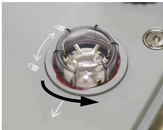
РИСУНОК 7-11 Снятие крышки клапана
