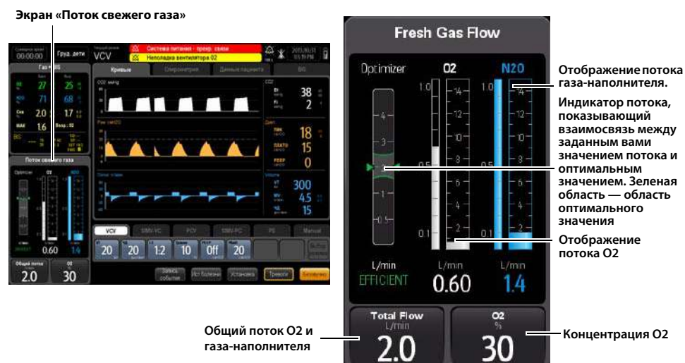
РИСУНОК 3-10 Электронная система управления потоком в режиме управления общим потоком
