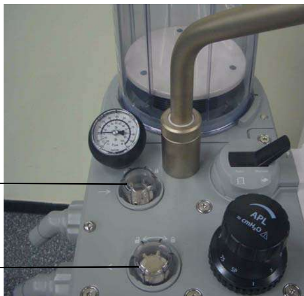
РИСУНОК 7-10 Положение клапанов вдоха и выдоха
